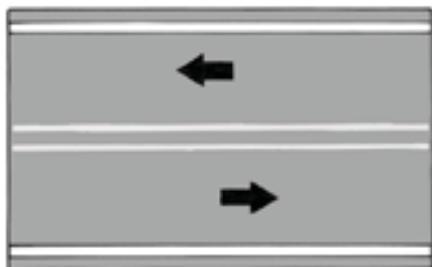
Carril doble, carretera de dos vías, se prohíbe sobrepasar en ambas direcciones, se permite cruzar la línea sólida para girar o en caso de avería.
