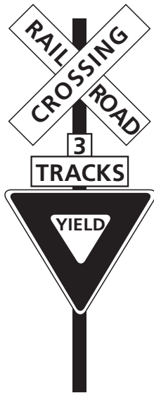
Figura 10-7: Vías Múltiples de Ferrocarril
