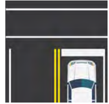
Línea Blanca de Pare y Paso Peatonal
