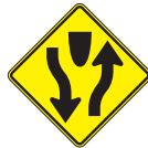
Comienzo de Carretera Dividida
